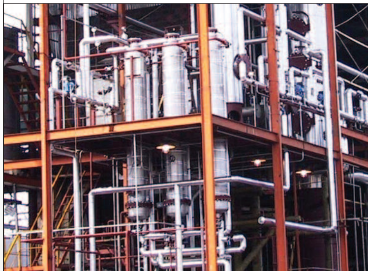
PRODUCTO ENFRIADO SIGUE PARA EL ADSORBEDOR DE CARBÓN PARA REDUCCIÓN DE COLOR
