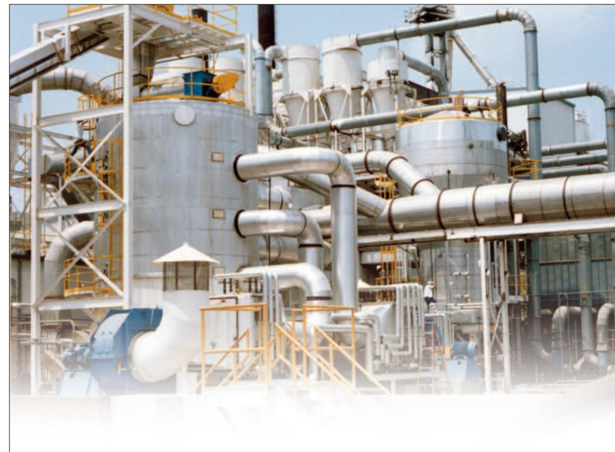
O DC tem provado ser uma maneira muito eficaz para secar e resfriar quase todos os tipos de farelo originados de extração por solventes. O DC inclui as vantagens do DTDC quando utilizado com um DT.
